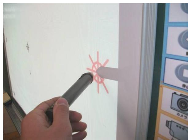
⑤ ホワイトスクリーン上にポイントが示されるので、左上から順に付属の電子ペンでタッチしていく。操作シートがある場合は、操作シートを左上→右下の順にタッチする。
