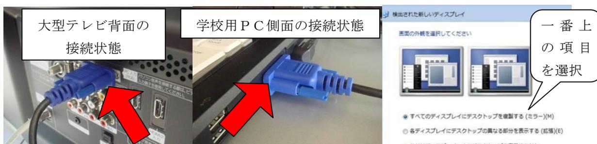
※RGBケーブル接続のときに、ネジを締めるものと締めないものがあります。
